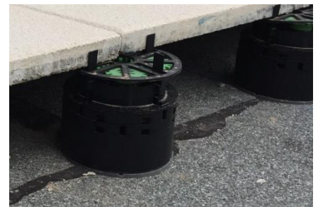
Abbildung 5: Anwendungsbsp. VOLFI-ZRV35 mit VT-A 2,5 aufgelegt. Als Erhöhung VT-U50, 2x VT-B und als Entkopplung VP-GKU untergestellt. Gesamthöhe Aufbau: 122,5 -137,5 mm
