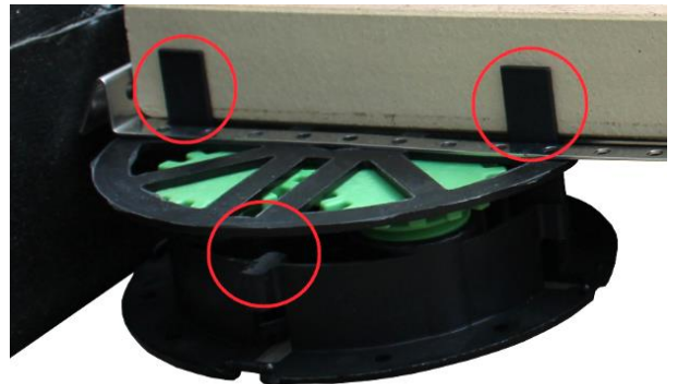
Abbildung 7: Anwendungsbsp. VOLFI-ZRV mit WAE-K. Für die Verlegung im Randbereich werden 2 gegenüberliegenden Fugenstege entfernt. Anschließend kann der Wandabstandhalter einfach in die I-Fuge des Stelzlagers eingelegt werden.
