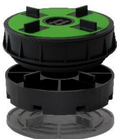
Abbildung 3: VT-U 30 mit Volfiplatte VP-GKU 4/10 auf Drehstelzylinder TL-V 30 (gesamt-Verstellbereich: 65-80mm). Kombination auch mit VT-U 10, 20, 40 oder 50 möglich.
