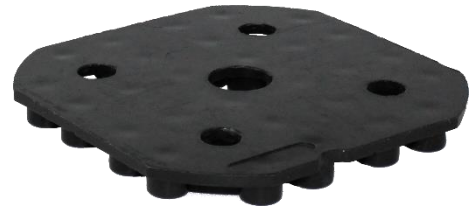
Abbildung 1: WK-U 0/00 ohne Fugenstege aus Spezial-Kunststoff; 10mm Aufbauhöhe. Bspw. zur mittigen Unterstützung bei großflächigen Plattenformaten.
