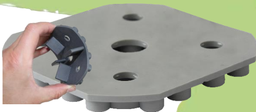
Abbildung 2: GK-U 0/00 ohne Fugenstege aus vollgummi Material; 10mm Aufbauhöhe. Bspw. zur mittigen Unterstützung bei großformatigen Platten und Trittschalldämmung.
